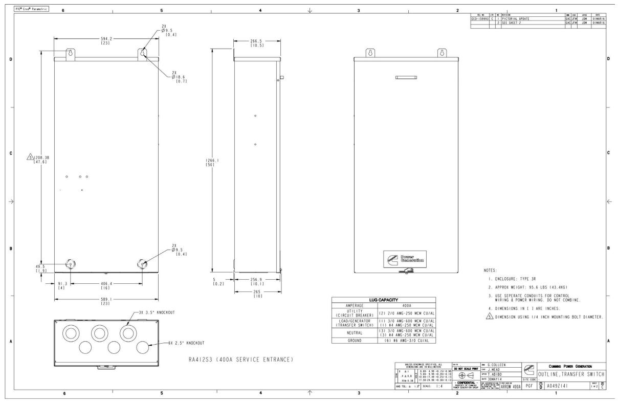
FIGURE 65. RA412S3 CONTROL BOX OUTLINE DRAWING
